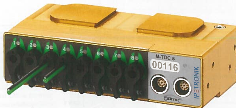
Bild 2: Das birnenförmige TDC-Thermokabel wird einfach in das Gerät geschoben und automatisch arretiert. Damit widersteht es hohen Zugkräften und verliert auch unter harschen Bedingungen nicht die Kontaktierung.
