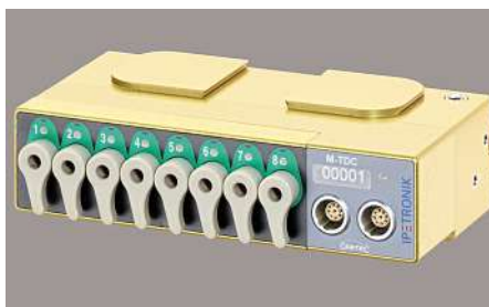
Bild 2: Das Modul M-TDC 8 besitzt eine spezielle Einführungsöffnung, die jenem birnenförmigen Leitungsquerschnitt des Kabels entspricht. Eine verpolte Messstelle wird verhindert. Das kompakte Thermomodul bietet acht Kanäle.
