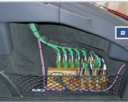
Bild 2. Kompromissbereit verbaut: Datenlogger im Kofferraum eines Erprobungsfahrzeugs
