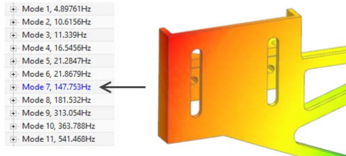
Analyse 1: Simulation der Strukturodynamik – Mode 7 wird als Bauteil-Resonanz bei 147,8 Hz identifiziert
